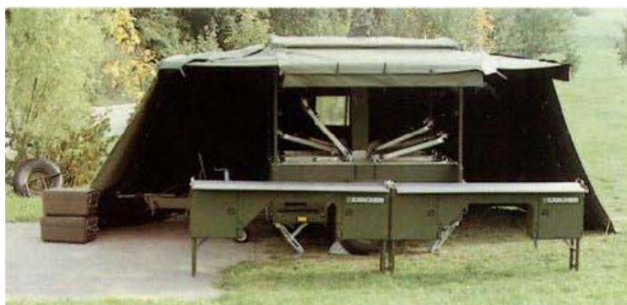
A szilárd utánfutó-álváz terepjáró képességet biztosít az MFK-nak
