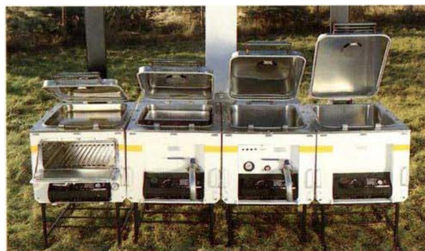
Négy MFK modul, amelyek önállóan használhatók alacsony hőfokon forraláshoz, hűsítéshez, tésztaütéshez és főzéshez
