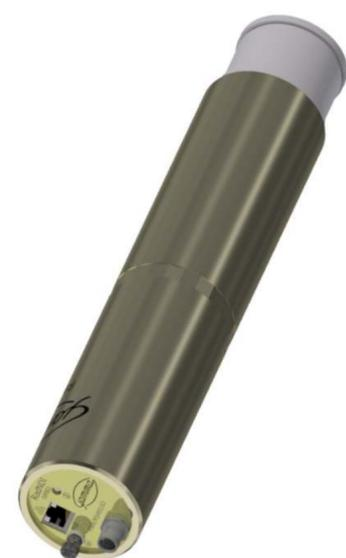
A RadNDI egy intelligens, kijelző nélküli szcintillációs detektor alfa-, béta-, gamma- és neutron sugárzások, vagy akár ezek kombinációjának egyidejű mérésére. A műszer alfa, béta, gamma és neutron spektrum és beütésszám [cps], becsült aktivitás és dózisteljesítmény (Gy/h, Sv/h) mérésére, valamint radionuklidok azonosítására alkalmas.
